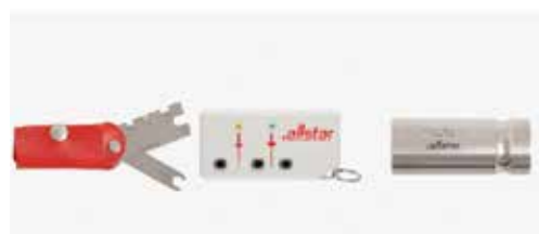
Quelle: Allstar Fechtausstatter Prüflehre, Prüfkästchen, Prüfgewicht 750 gr.
